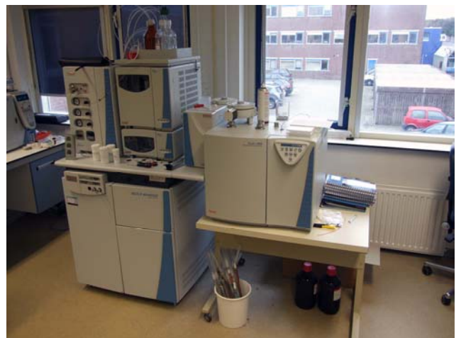
Met de isotoop-ratio massa spectrometer (irMS) vinden de stabiele isotopen analyses plaats. De eerste resultaten lijken aan te geven dat richting het oosten het stikstofsignaal steeds hoger wordt.
