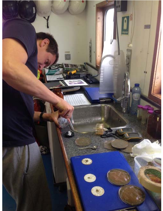
De glasparsels stopt Holthuijsen vervolgens in gefilterd zeewater. Na het filteren van de water/diatomee suspensie blijven de diatomeeën op de filter achter.
