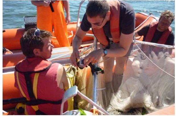
Installatie van de onderwatercamera op de boomkor.
